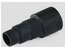
Universal-Adapter mit Innengewinde 32 mm zur universellen Verbindung von Maschinen mit 25-32 mm Ø-Absauganschluss mit 32 mm-Saugschlauch (ohne Clip-Anschluss) oder mit Saugschlauchverlängerung (296.953). Adapter auf 3 verschiedene Durchmesser zuschneidbar.
